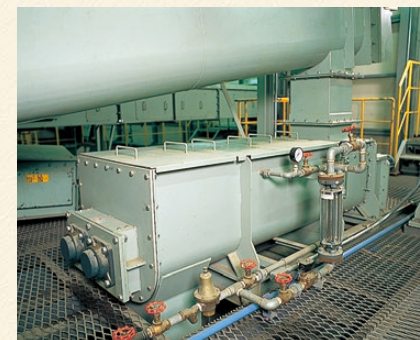
混練機／粉塵ダストを加水し飛散防止します。
