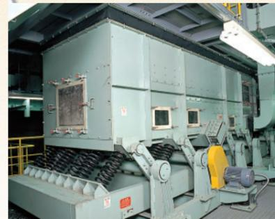
振動式風力1次選別機/混合廃棄物を可燃物と不燃物に粗選別します。
