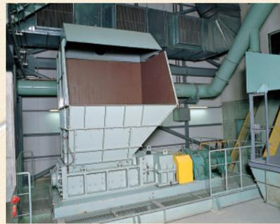
2軸破砕機 (プラスチック前処理破砕機)
