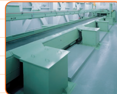
混合廃棄物処理ライン用手選別コンベヤ
