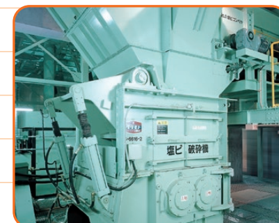
塩ビ系廃プラスチック類処理ライン用破碎機
