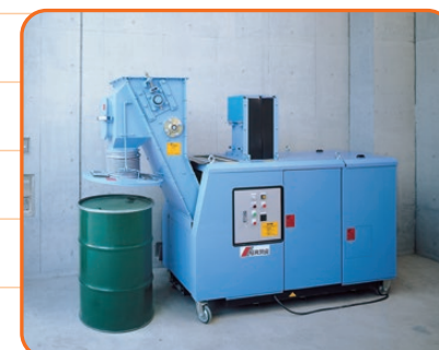
蛍光灯類処理ライン用破碎機 (水銀使用製品産業廃棄物)
