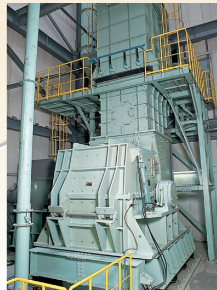
破碎機(CT10/1500型ハンマクラッシャー)
