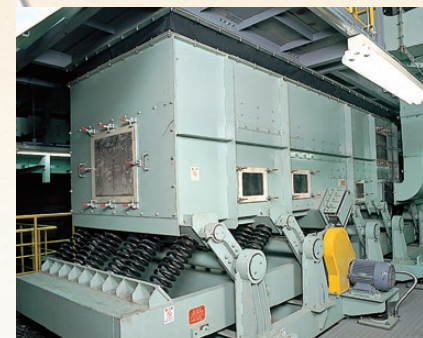
振動式風力1次選別機／混合廃棄物を可燃物と不燃物に粗選別します。
