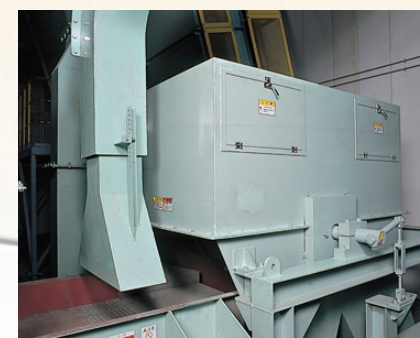
鉄精選機／磁選機で回収した鉄の純度を向上します。
