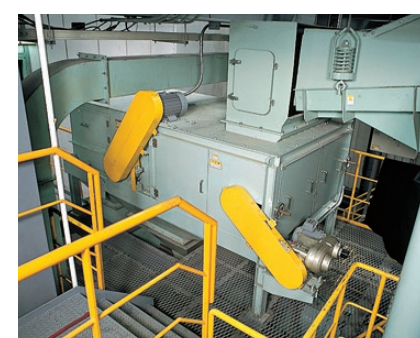
アルミ選別機／混合物からアルミを回収します。
