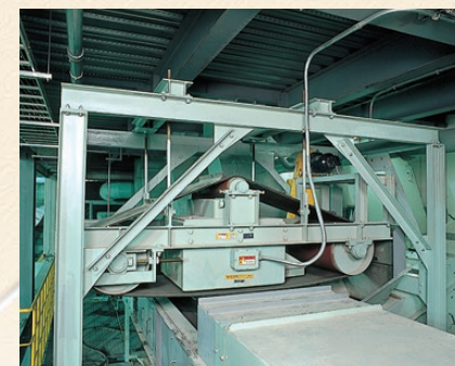
磁力選別機／各搬送ライン上で、鉄を回収します。
