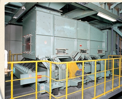
スクリーン／混合廃棄物を大きさと分けします。
